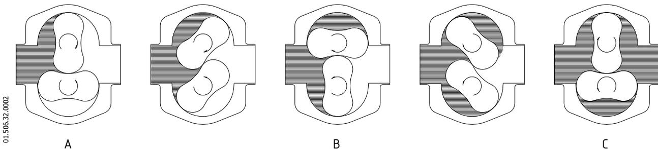
**A:** Al girar los lóbulos, el espacio por el lado de aspiración aumenta porque un lóbulo se aleja del otro, provocando así un vacío parcial que conduce al líquido a la cámara de bombeo.
